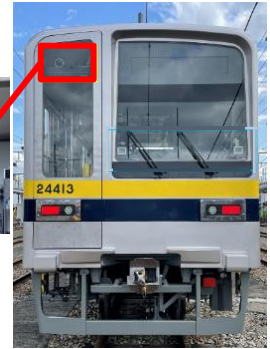
△前方障害物検知システム検証試験の様子
