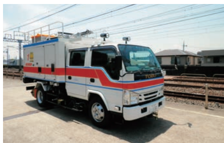
架台を格納した電気検測車
