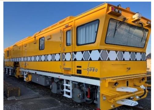
△バラストスイーパー（排出ガス規制適合車両）
