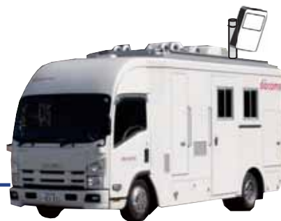
5G伝送装置（基地局） 搭載車
