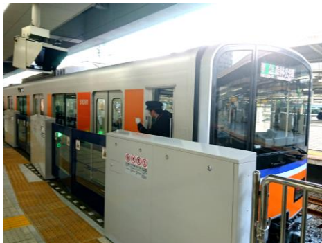
△ 池袋駅ホーム 1番ホーム ホームドア（既設置）
