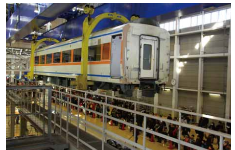
「車体の吊り上げ」
