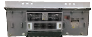
500系VVVFインバーター制御装置
