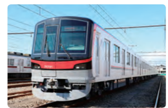
アルミ合金製の軽量車体
