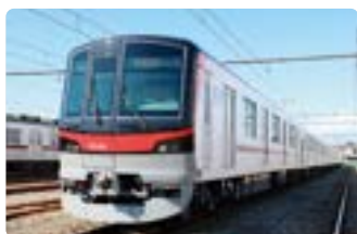
アルミ合金製の軽量車体
