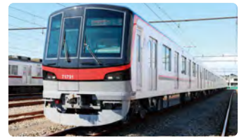
アルミ合金製の軽量車体
