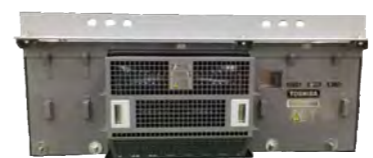
500系VVVFインバータ制御装置
