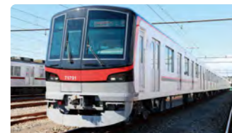
アルミ合金製の軽量車体
