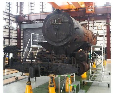
△復元作業中のSL復元機 C11形123号機
