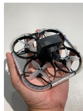
△点検に使用したマイクロドローン
