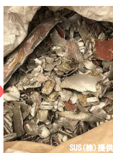
新幹線車両のアルミスクラップ材（左） と再生アルミビレット（右）
