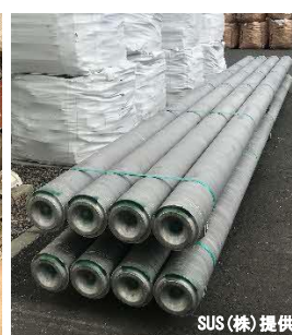
新幹線車両のアルミスクラップ材（左） と再生アルミビレット（右）
