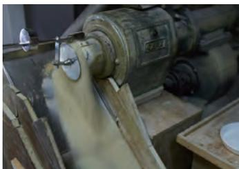
その日の気温と湿度、米の色と香り、精米時の音に気を配りながら、昔ながらの精米機で長い時間をかけ、磨き上げていくのはまさに職人技
