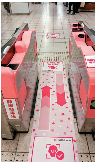
ウォークスルー型顔認証改札機（右側はカメラ部分の拡大）
