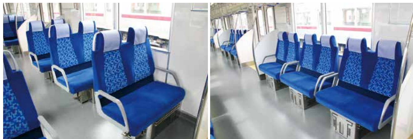
TJライナーのシート。時間帯によってクロスシートかロングシートに切り替ええるL/Cカーであることが最大の特徴
