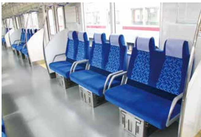
TJライナーのシート。時間帯によってクロスシートかロングシートに切り替えできるL/Cカーであることが最大の特徴
