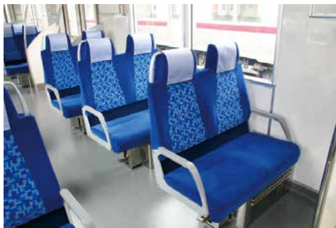
TJライナーのシート。時間帯によってクロスシートかロングシートに切り替えできるL/Cカーであることが最大の特徴
