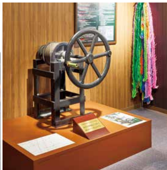
事故当時、第37号踏切道で踏切保安係が遮断機の昇降のために操作していたハンドルは南栗橋の総合教育訓練センターに保管されており、展示パネルと共に事故の詳細を後世に伝えている。また、新入社員教育の際にも必ず説明され、安全運行の思いを胸に刻む
