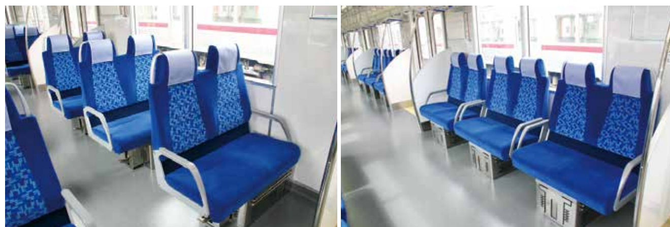
TJライナーのシート。時間帯によってクロスシートかロングシートに切り替えられるL/Cカーであることが最大の特徴
