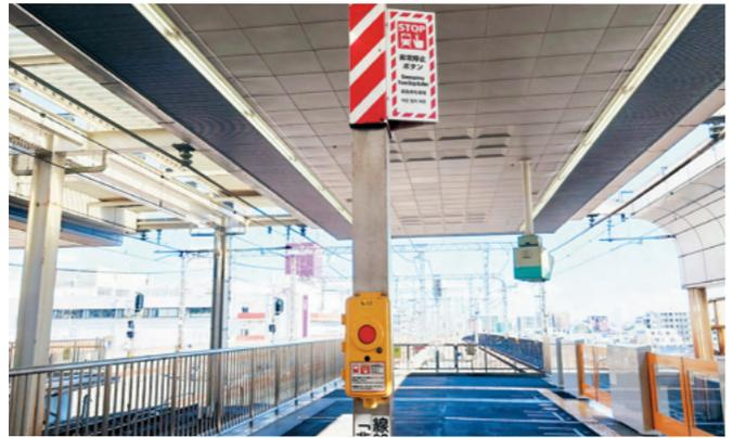
列車を緊急停止させることを目的として、ホーム上の複数か所に「非常停止ボタン」を設置しています。赤白の注意看板の傍に設置しています。
