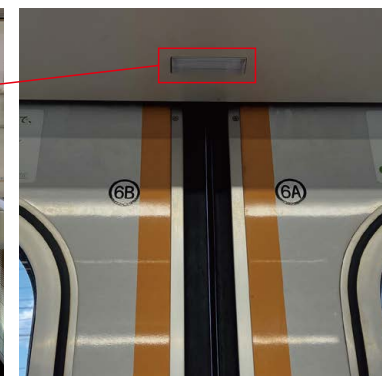
【扉開閉予告灯】
