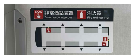
【非常通話装置(非常通報器)の場所を示す車内の掲示】
