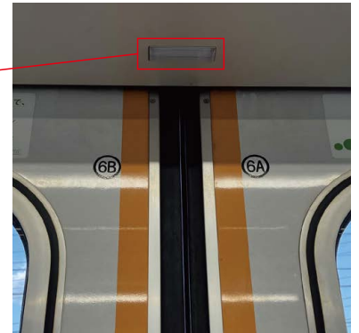
【扉開閉予告灯】
