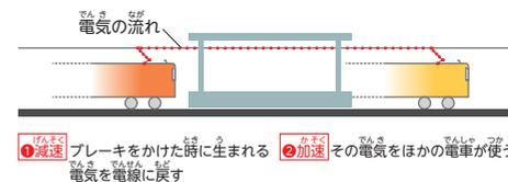
ブレーキをかけた時に発生するエネルギーを電気に変えて、その電気を電線(架線)にもどしてほかの電車にも使えるようにした仕組みだよ。エネルギーをムダなく使っているんだ。
