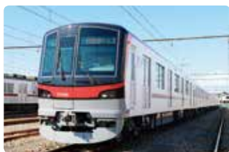
アルミ合金製の軽量車体
