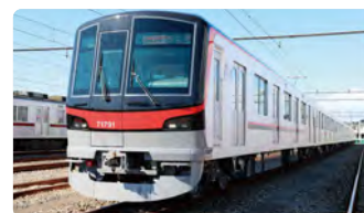
アルミ合金製の軽量車体
