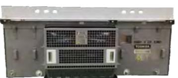
500系VVVFインバータ制御装置
